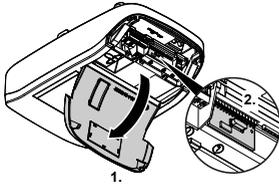
Abb. 10: Abdeckung des Antriebskopfes öffnen und Funkmodul bestimmen
