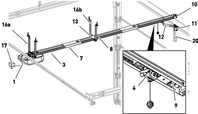
Fig. 1: Vista general del producto - montaje
